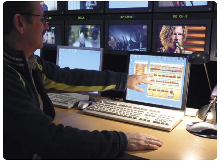
▲ Teknik Müdür Jacques Schepers akışın kalbini gösteriyor. Sinyaller iki Astra transpondörüne, Eutelsat transpondörüne veya ya da bir kablo şebekesine tek bir mouse'a tıklayarak yönlendirilebiliyor.
