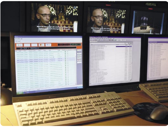
▲ Akış otomatik olarak gerçekleşiyor: Bilgisayarlar bir programın ardından diğerini çalıştırıyor. Sağdaki monitör EVS'den eski MPEG-2 sistemini gösterirken, soldaki monitör ise Grass Valley firmasının MPEG-4 sistemiyle çalışıyor.
