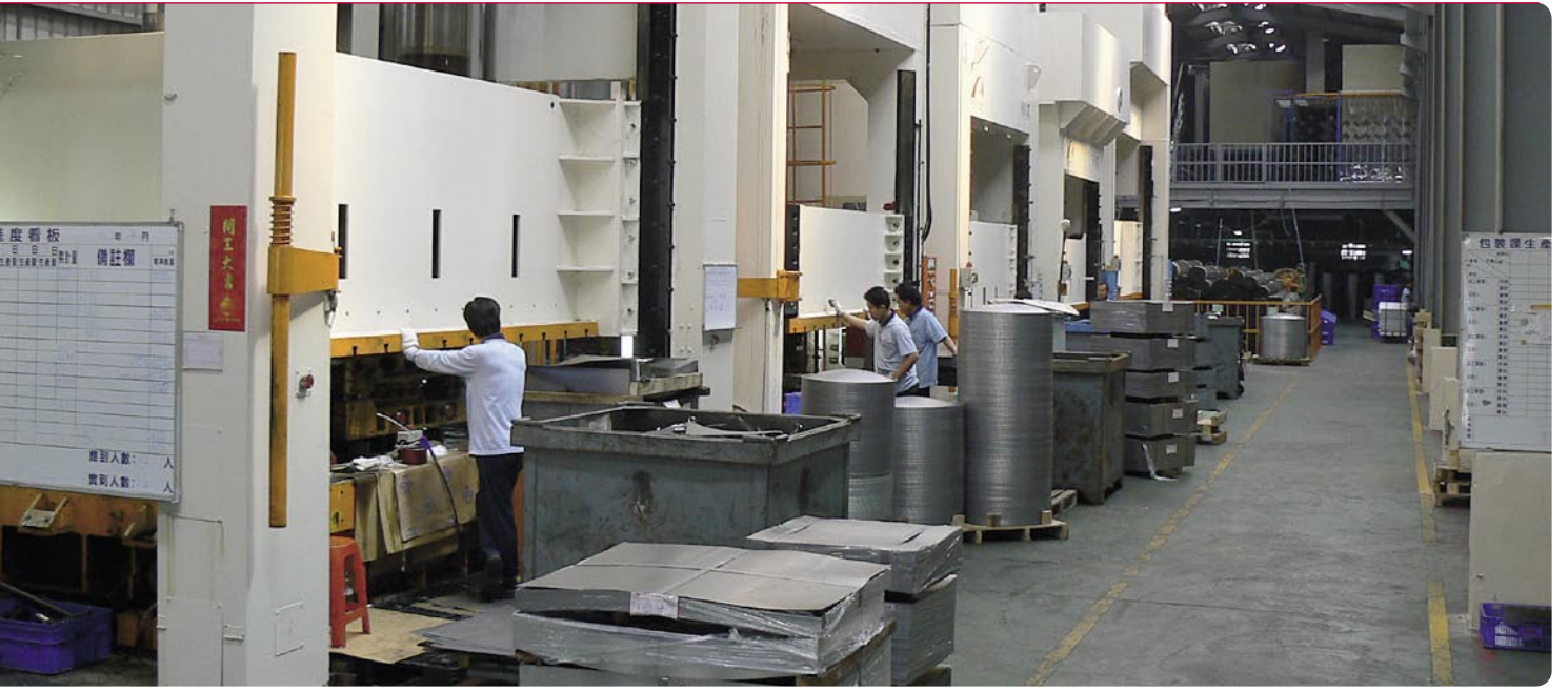
Pres makinesi: Önceden kesilmiş metal levha (öndeki palet üzerinde) prese düz olarak konuyor ve offset bir anten olarak çıkıyor.
