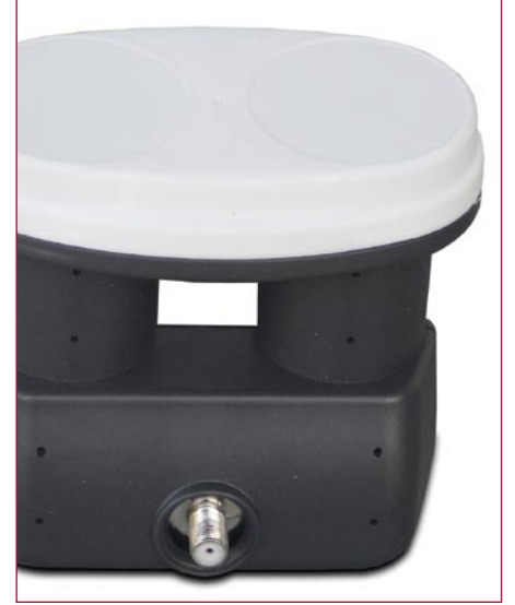
Monobloğun altındaki delikler, yoğunlaşan nemin dışarı akmasını sağlayarak, iç kısmı kuru tutuyor.
