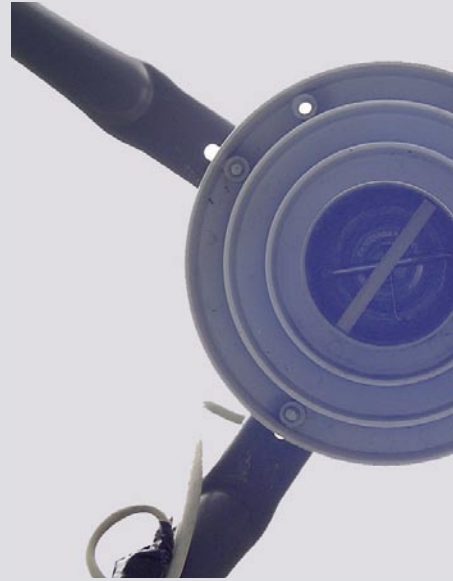
▲ Feed ağzının içinden bir görünüş: Dairesel polarizasyonlu sinyallerin izlenebilmesi için gerekli dielektrik hemen göze çarpıyor. Bunu yerinden çıkardığımızda tekrar lineer sinyallere geçebilirsiniz.
