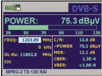
13° doğu HOTBIRD uydusu RAI transpondöründe sinyal ölçümü. Geleneksel tekli LNB (sol) ve Global Invacom optik LNB (sağ) |
