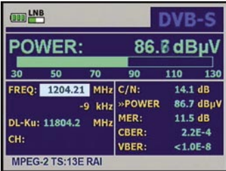
13° doğu HOTBIRD uydusu RAI transpondöründe sinyal ölçümü. Geleneksel tekli LNB (sol) ve Global Invacom optik LNB (sağ) |
