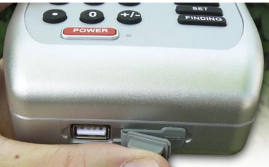
Cihazı bilgisayar bağlamak için kullanacağınız USB arabirimi güç girişinin hemen yanında
