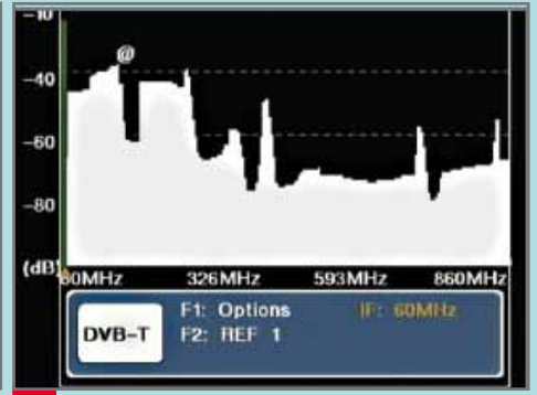
Aktif frekanslar spektrum analizör ekranında kolayca tespit edilebiliyor!
