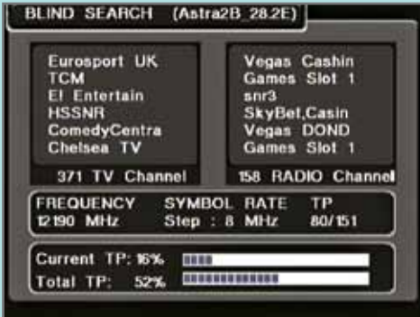
Kör Tarama fonksiyonu ile hafızadaki listede olmayan transpondörleri bulabilirsiniz |
