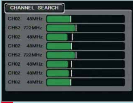
DVB-T sinyallerinde Çoklu Kanal Taramada 8 kanalın Sinyal Kalitesini eşzamanlı olarak görebilirsiniz!
