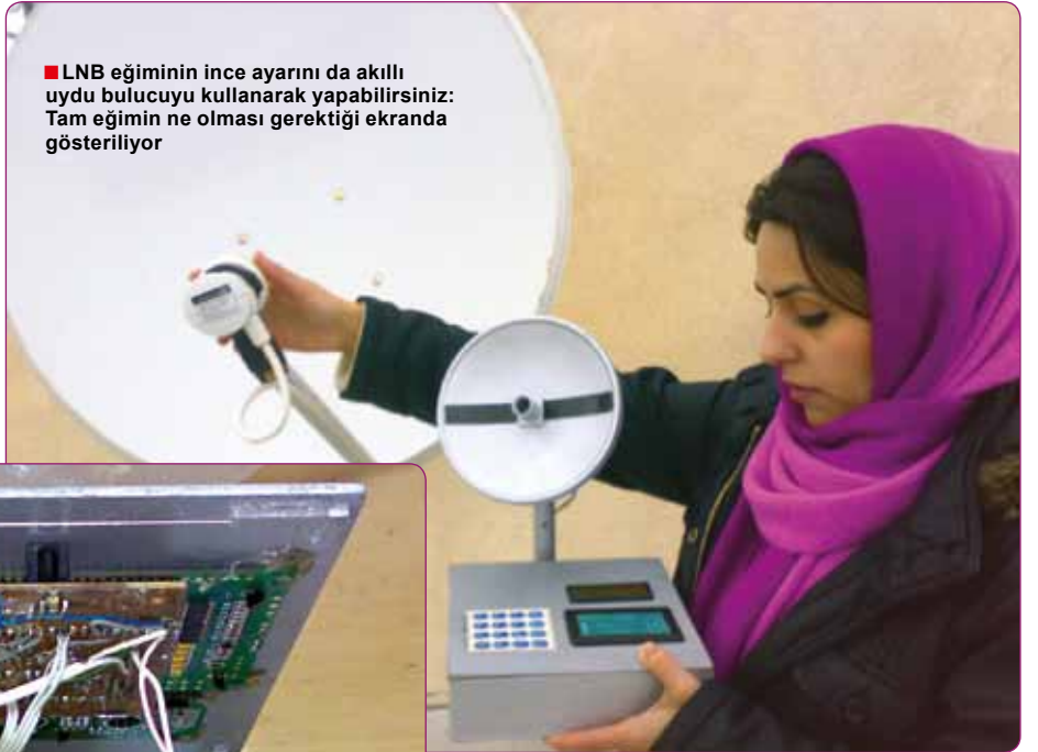
■ Akıllı uydu bulucu böyle kullanılıyor: İzlemek istediğiniz uyduların yerini gösteriyor ve size sadece gerçek anteni ona paralel hale getirmek kalıyor.
