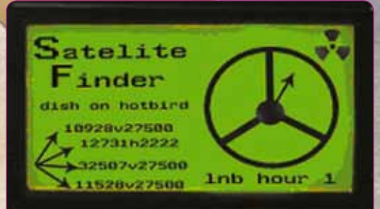
■ Akıllı uydu bulucunun ekranı LNB eğimini ve en güçlü transpondörü gösteriyor.
